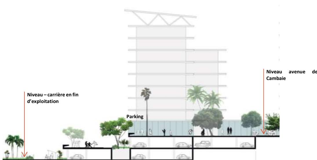
*Principe du stationnement en profitant de la déclivité avec les carrières. Ces parkings bénéficient d'une façade ouverte amenant lumière naturelle et ventilation et facilitant la reconversion si nécessaire.*
